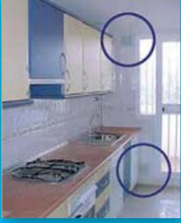
Los recintos donde se encuentran instalados los aparatos que consumen el gas (por ejemplo, su caldera y/o cocina), deben ser adecuados y disponer de suficiente ventilación al exterior o a un patio de ventilación, por medio de rejilla de salida de aire o sistema similar(1).
